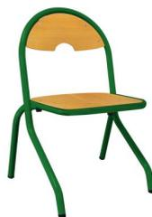
Chaise 4 pieds appui sur table T2 vert. Empilable. Tube acier rond Ø25x2mm. Assise et dossier encastrés. Assise en appui sur table avec embouts de protections. Travers de renfort entre piètements. Soudures renforcées. Peinture époxy. Embouts polyéthylène insonore et non tachant. Garantie 10 ans.
